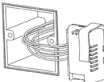
2 将电线和电源模块依图所示放入安装盒内。
