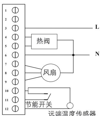
应用 2: 两管制单冷接线图
